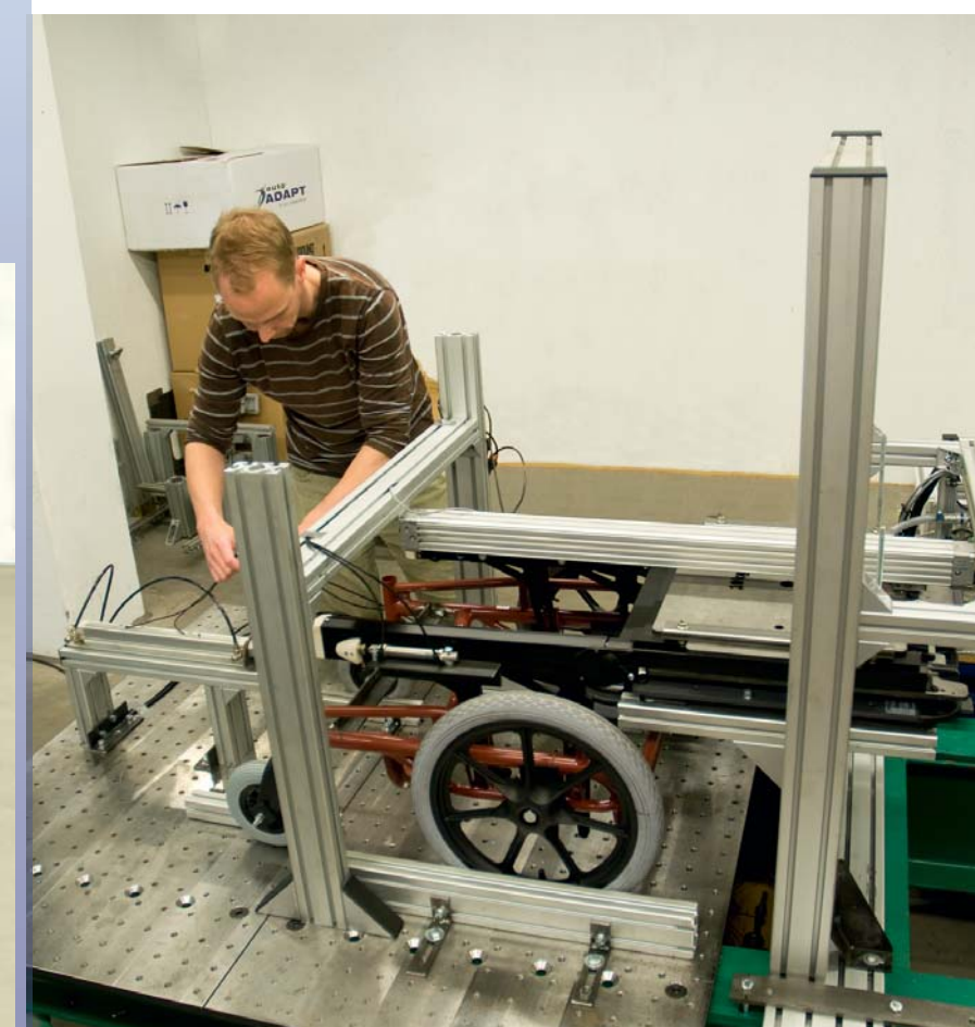
Belastungstest des Carony Kopplungsmechanismus.
