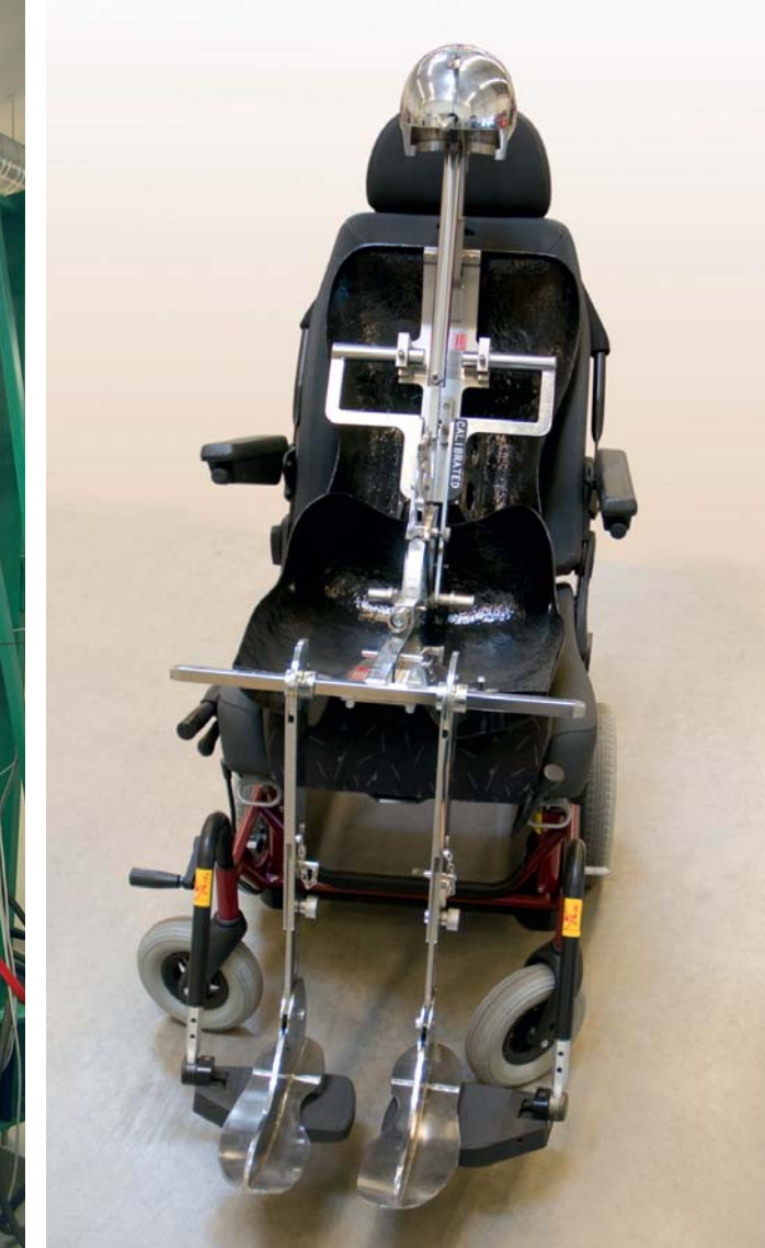
H-Punkt-Dummy zum Testen der Sitzverankerung, Sicherheitsgurverankerung, Kopfstütze etc.
